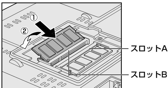
増設メモリの切れ込みを、増設メモリスロットのコネクタのツメに合わせて、しっかりと差し込みます。
