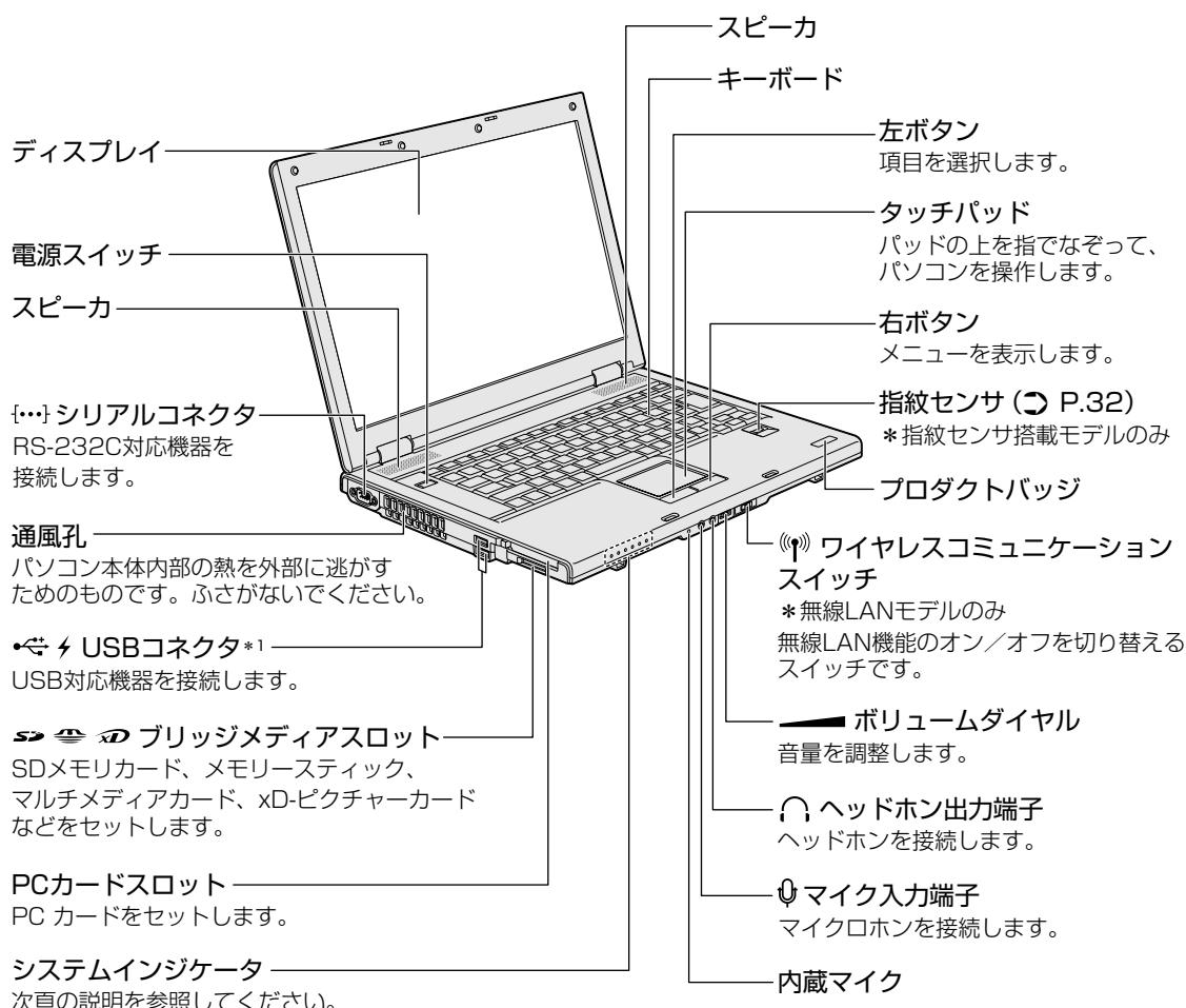
\* 1 設定を行うと、パソコン本体の電源が入っていない状態でも、USBコネクタから外部機器に電源を供給することができます。
