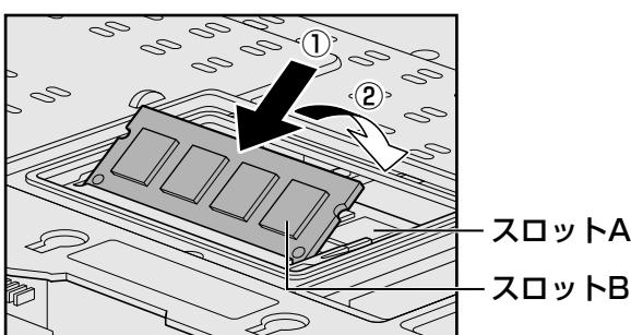
パソコンの裏面を表にした状態で、下段がスロットA、上段がスロットBです。
