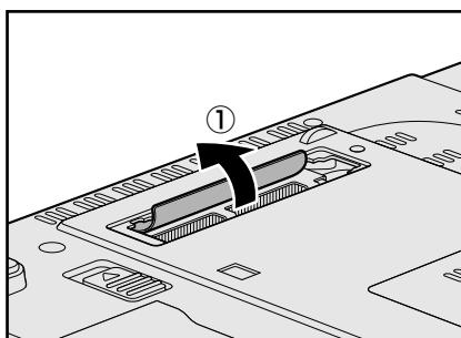
**6** 冷却モジュールカバーを矢印の方向にスライドさせて取り付ける
