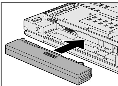
バッテリパックがはずれないように、矢印方向にバッテリ安全ロックがスライドされているか、確認してください。
