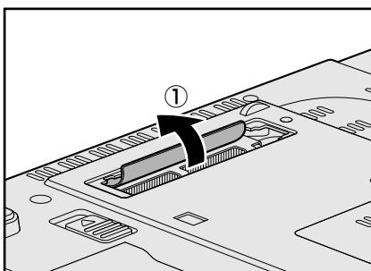
**6** 冷却モジュールカバーを矢印の方向にスライドさせて取り付ける
