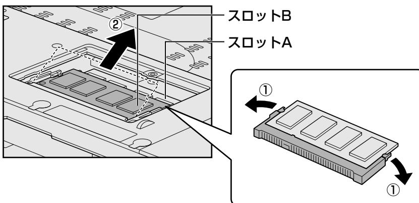
パソコンの裏面を表にした状態で、下段がスロットA、上段がスロットBです。
