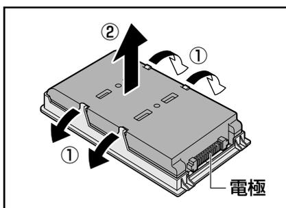
**8** 交換するバッテリーパックをバッテリーカバーに取り付ける
