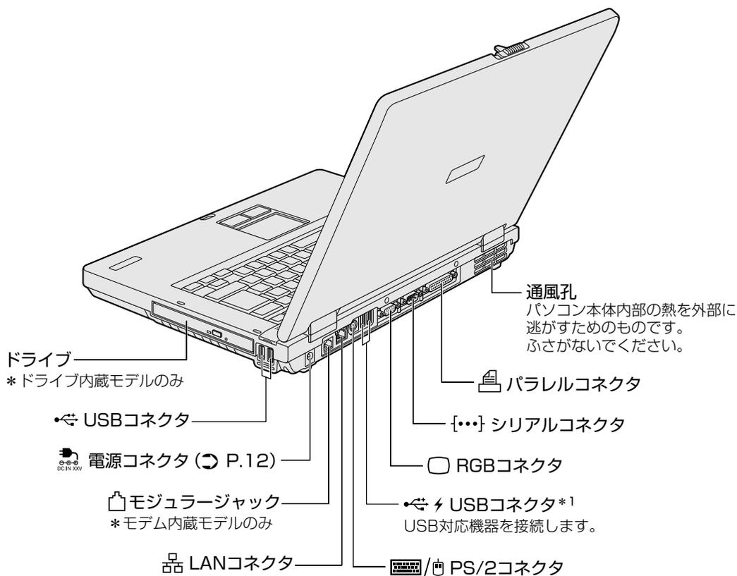
\*1 設定を行うと、パソコン本体の電源が入っていない状態でも、USBコネクタから外部機器に電源を供給することができます。
