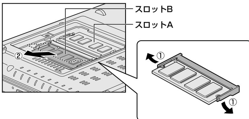
パソコンの裏面を表にしてディスプレイ開閉ラッチを手前にした状態で、右側がスロットA、左側がスロットBです。
