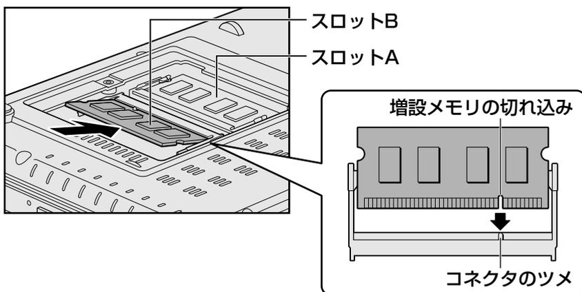
パソコンの裏面を表にしてディスプレイ開閉ラッチを手前にした状態で、右側がスロットA、左側がスロットBです。
