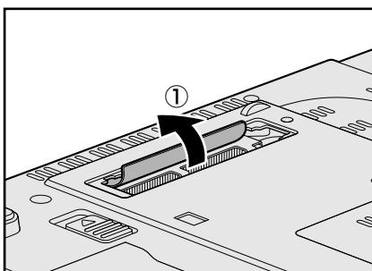
**6** 冷却モジュールカバーを矢印の方向にスライドさせて取り付ける
