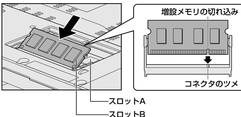
パソコンの裏面を表にした状態で、下段がスロットA、上段がスロットBです。
