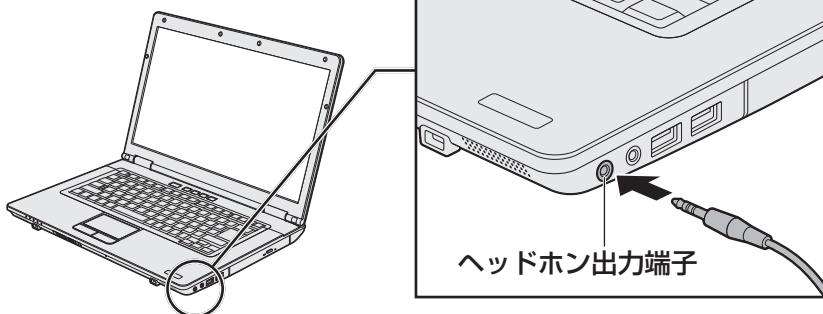
取りはずすときは、ヘッドホン出力端子からヘッドホンのプラグを抜きます。
