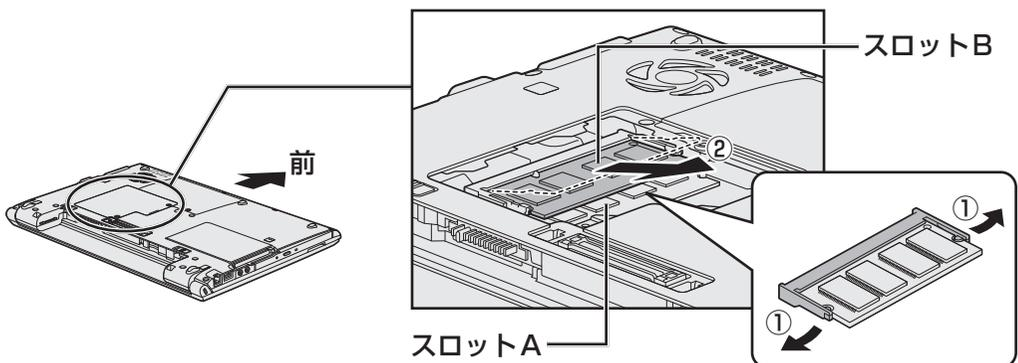
パソコンの裏面を表にした状態で、下段がスロットA、上段がスロットBです。斜めに持ち上がったメモリを引き抜きます。
