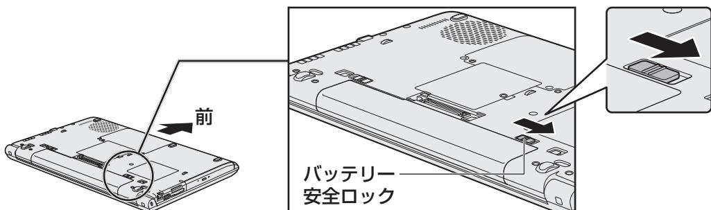
**5** バッテリー・リリースラッチをスライドしながら①、バッテリーパックを取りはずす②
