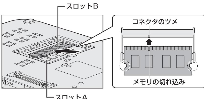
パソコンの裏面を表にした状態で、下段がスロットA、上段がスロットBです。メモリの切れ込みを、メモリスロットのコネクタのツメに合わせて、しっかりと差し込みます。このとき、メモリの両端（上図○で囲んだ部分）を持って差し込むようにしてください。
