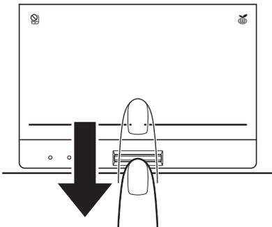
同じ指を3回認識させてください。指紋センサーに指をすべらせると、画面の3つのボックスに、1回ごとの指紋データの読み取り結果が表示されます。読み取りに成功すると、ボックスの下に「良いイメージ」と表示されます。
