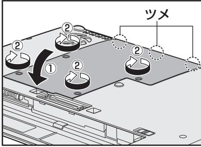
メモリカバーは左図 ① で囲んだ部分にあるツメを本体のくぼみに合わせてから閉じてください。
