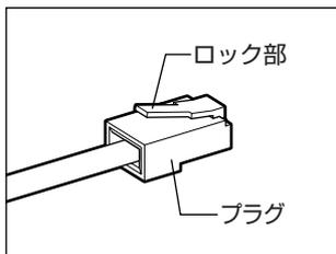
LAN ケーブルをはずしたり差し込むときは、プラグの部分を持って行ってください。また、はずすときは、プラグのロック部を押しながらずしてください。ケーブルを引っ張らないでください。LAN ケーブルは市販のものを使用してください。モジュラーケーブルは、LAN コネクタに接続できません。
