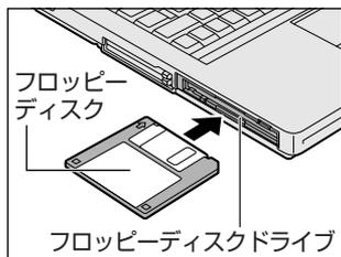
カチッと音がするまで挿入します。正しくセットされるとイジェクトボタンが出てきます。
