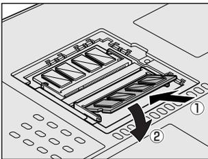
増設メモリの切れ込みを、増設メモリスロットのコネクタのツメに合わせて、しっかり差し込みます。フックがかりにくいときは、ペン先などで広げてください。このとき、増設メモリの両端（切れ込みが入っている部分）を持って差し込むようにしてください。
