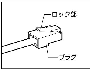
LAN ケーブルをはずしたり差し込むときは、プラグの部分を持って行ってください。また、はずすときは、プラグのロック部を押しながらはずしてください。ケーブルを引っ張らないでください。LAN ケーブルは市販のものを使用してください。モジュラーケーブルは、LAN コネクタに接続できません。
