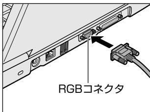
外部ディスプレイを接続してパソコン本体の電源を入れると、本体は自動的にその外部ディスプレイを認識します。
