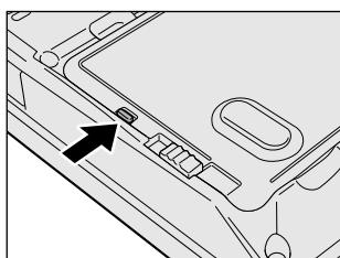
バッテリパックがはずれないように、バッテリ安全ロックは必ず行ってください。
