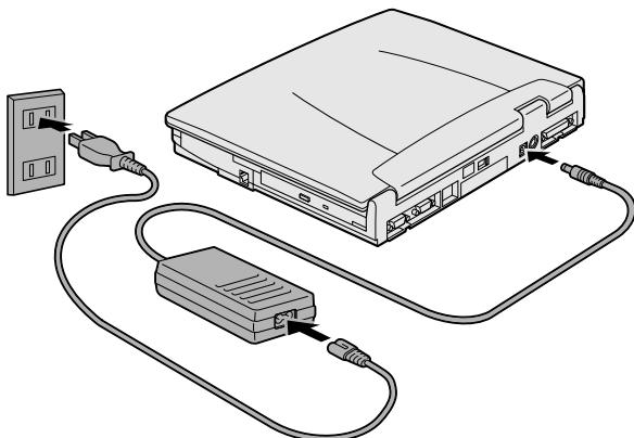
電源コードを接続したら、DC IN LED が緑色、Battery LED がオレンジ色に点灯するのを確認してください。
