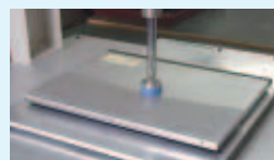
一点加圧試験 ノートPCの各部分に強い力が加わったと想定して耐久性を調べる試験です。
