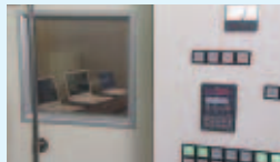
低温・高温試験 ノートPCの動作保証温度で、実際に動作させてみる試験です。
