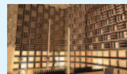
放射電磁界イミュニティ試験 ノートPCに電磁波を照射して誤作動の有無を確認する試験です。さまざまな電磁波が飛び交うようになった今、この試験の重要性が増しています。
