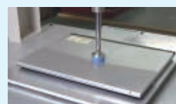
一点加圧試験 ノートPCの各部分に強い力が加わったと想定して耐久性を調べる試験です。
