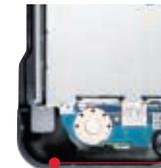
コーナー部分が中空構造のため、万一の落下時に衝撃を分散。PC内部へのダメージを軽減します。
