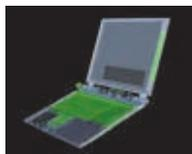
3次元CADを活用し、放熱性、静音性、軽量化や部品点数の軽減を考慮した筐体設計をおこなっています。たとえば、設計に用いたCADデータをベースに、熱、耐久性、剛性などのシミュレーションをおこない、試作前の段階で問題を発見し、設計にフィードバック。こうした総合的なアプローチにより設計品質を向上させています。
