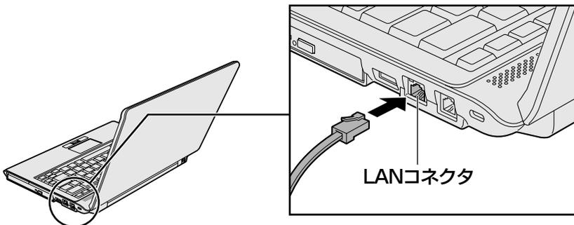
3 LANケーブルのもう一方のプラグを接続先のネットワーク機器のコネクタに差し込む
