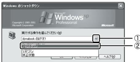
Windows を終了したあと、パソコン本体の電源が自動的に切れます。パソコン本体の電源が切れると、Power LED が消灯します。
