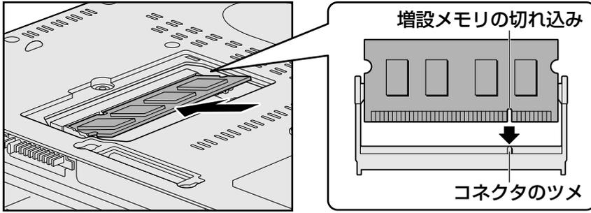
増設メモリの切れ込みを、メモリスロットのコネクタのツメに合わせて、しっかり差し込みます。
