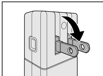
この場合、ACアダプタにウォールマウントプラグを接続する手順が、接続手順の①となります。以降の手順は、電源コードを使用する場合と同様です。
