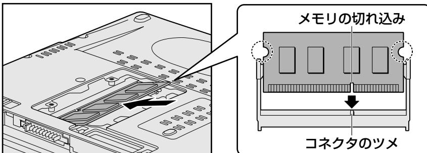
メモリの切れ込みを、メモリスロットのコネクタのツメに合わせて、しっかり差し込みます。
