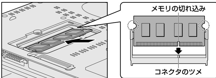
メモリの切れ込みを、メモリスロットのコネクタのツメに合わせて、しっかり差し込みます。
