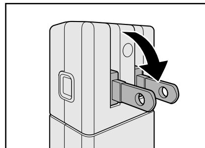
この場合、ACアダプターにウォールマウントプラグを接続する手順が、接続手順の①となります。以降の手順は、電源コードを使用する場合と同様です。
