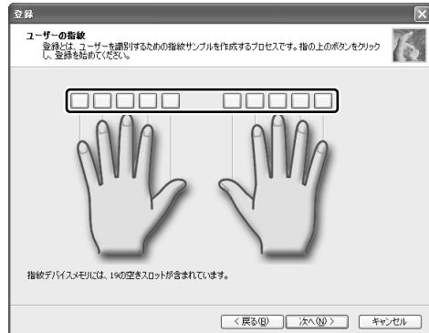
第1関節を指紋センサの上に置き、手前に引くようにすべらせてください。同じ指を3回読み取らせます。画面中央に読み取り画面が表示され、1回指紋読み取りが成功するごとにチェックがつきます。3回とも指紋の読み取りができた場合、「成功」と認識画面の下部に表示され、登録した指を示すボックスに指紋イラストが表示されます。
