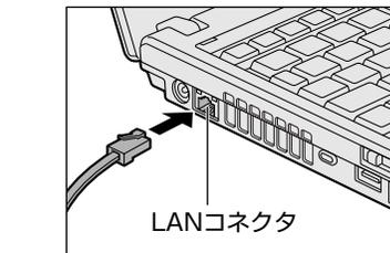
3 LAN ケーブルのもう一方のプラグを接続先のネットワーク機器のコネクタに差し込む
