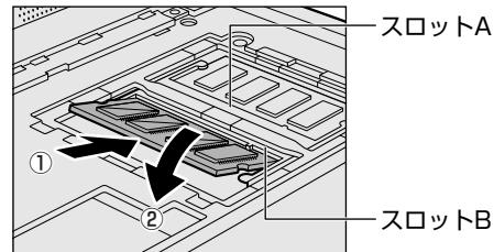
増設メモリの切れ込みを、増設メモリスロットのコネクタのツメに合わせて、しっかりと差し込みます。フックがかかりにくいときは、ペン先などで広げてください。
