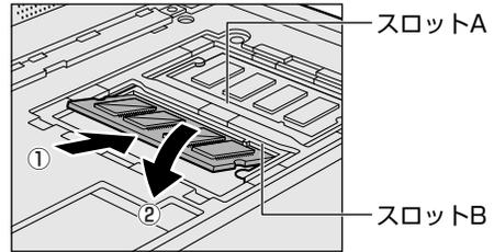
増設メモリの切れ込みを、増設メモリスロットのコネクタのツメに合わせて、しっかり差し込みます。フックがかかりにくいときは、ペン先などで広げてください。
