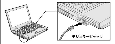
もう一方のモジュラーケーブルのプラグを電話機用モジュラージャック に差し込む
