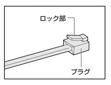
モジュラーケーブルのプラグの一方をパソコン本体のモジュラージャッ クに差し込む
