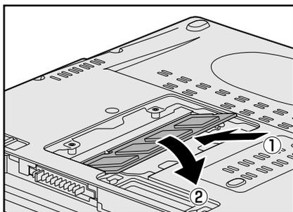
増設メモリの切れ込みを、メモリスロットのコネクタのツメに合わせて、しっかり差し込みます。
