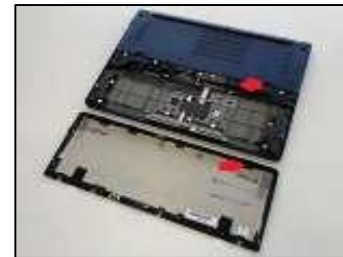
金属筐体内部のプラスチック部品
