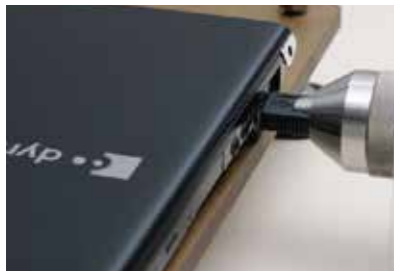
■コネクタこじり試験 コネクタ部分にこじり(回転)によるストレスを加え、接続部の耐久性を確認します。
