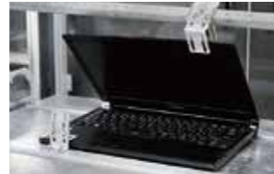
■ヒンジ開閉試験 ディスプレイの開閉を連続的に実施し、PCのヒンジへの影響を確認します。
