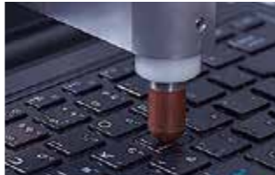
■キーボードランポリン試験 押したキーの周囲がどれくらいたわむかを検証。ミリ単位で測定します。
