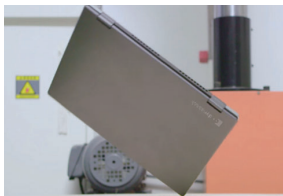
■26方向からの76cm落下テスト ※写真の製品はRJ74ではありません。
