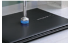
一点加圧試験
