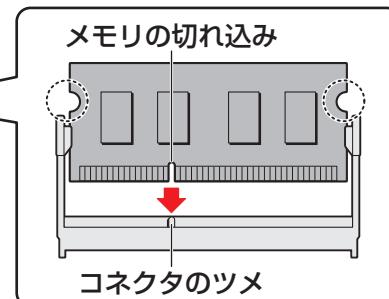
メモリの切れ込みを、メモリスロットのコネクタのツメに合わせて、しっかりと差し込みます。このとき、メモリの両端（上図○で囲んだ部分）を持って差し込むようにしてください。
