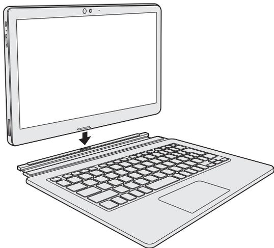
本体に内蔵されている磁石で、タブレットと薄型・軽量キーボードが固定されます。
