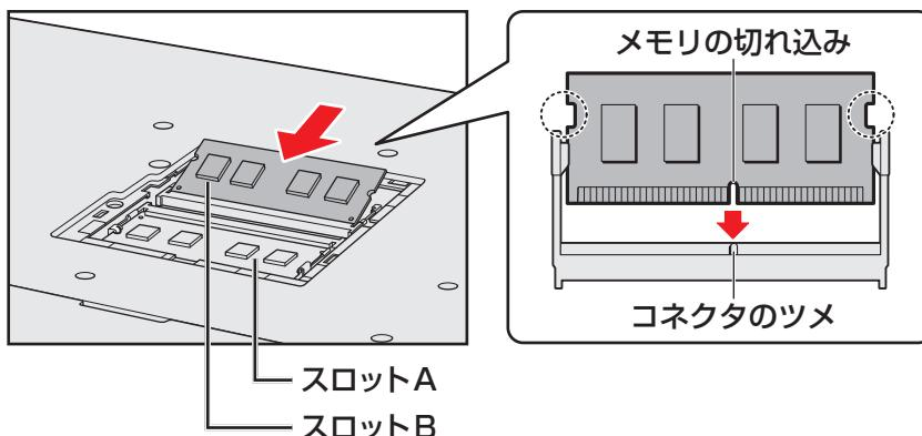
メモリの切れ込みを、メモリスロットのコネクタのツメに合わせて、しっかりと差し込みます。このとき、メモリの両端（上図○で囲んだ部分）を持って差し込むようにしてください。
