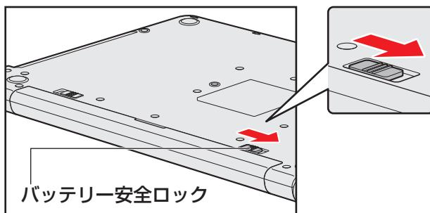
**5** バッテリー・リリースラッチをスライドしながら①、バッテリーパックを取りはずす②
