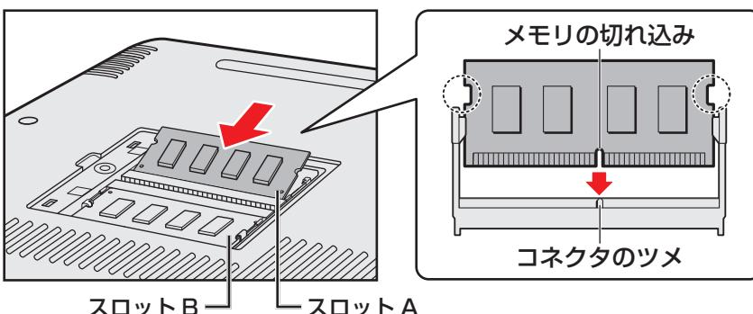
メモリの切れ込みを、メモリスロットのコネクタのツメに合わせて、しっかりと差し込みます。このとき、メモリの両端（上図○で囲んだ部分）を持って差し込むようにしてください。
