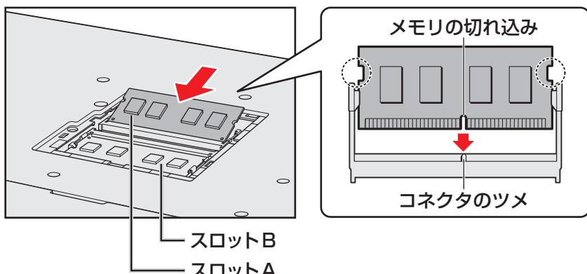
メモリの切れ込みを、メモ里斯ロットのコネクタのツメに合わせて、しっかり差し込みます。このとき、メモリの両端（上図○で囲んだ部分）を持って差し込むようにしてください。
