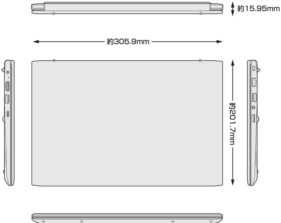
**2 右側面にUSB Type-Aコネクタを2つ搭載しているモデル**
