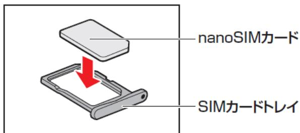
5. nanoSIMカードがSIMカードトレイに正しくセットされていることを確認して、SIMカードトレイをゆっくり差し込む
