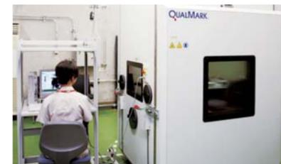
高加速寿命試験装置「HALT (Highly Accelerated Life Test)」を使い、数年後に起こりうるトラブルを検証。
