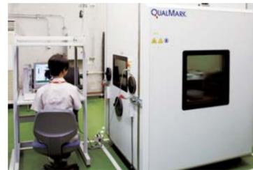
HALTでは、実験装置の中で、数年分の負荷に相当する急激な温度変化(-100℃~95℃)や強い振動などのストレステストを製品が壊れるまで行うことで、数年後に発生するかもしれない故障の可能性を見つけ出し、品質改善に活用。
