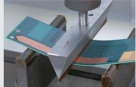
基板や組み立てた状態のタッチパネルなど、押圧に対する剛性を試験し、断線などの発生する限界レベルを検出。
