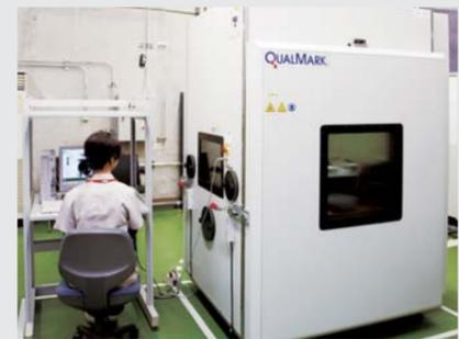
HALTでは、実験装置の中で、数年分の負荷に相当する急激な温度変化 (-100℃~100℃) や強い振動などのストレスを製品に壊れるまで行うことで、数年後に発生するかもしれない故障の可能性を見つけ出し、品質改善に活用。
