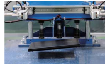
さまざまな角度から製品を落下させて、各部位の耐久性を調べます。
