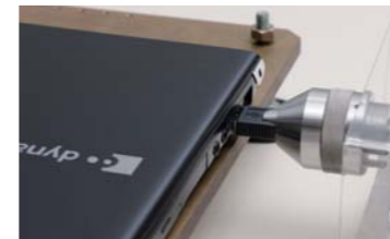
コネクタ部分に「こじり」(回転)によるストレスを加え、接続部の耐久性を確認します。
