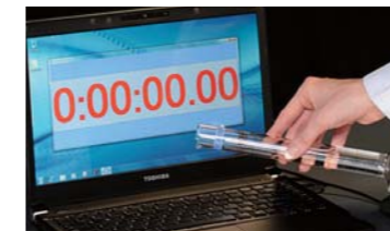
動作中のノートPCのキーボード部に30ccの水を注ぎ、データを保存するまでの一定時間、電源シャットが起きないことを確認しました。
