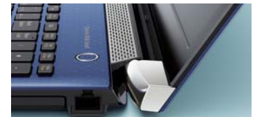
ユーザー側に少し起きているスピーカーグリル。グリル孔の形状と工夫した並びで音抜けもよい
