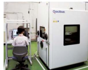
HALTでは、実験装置の中で、数年分の負荷に相当する急激な温度変化(-100℃~95℃)や強い振動などのストレスを製品が壊れるまで行い、数年後に発生するかもしれない故障の可能性を見つけ出します。
