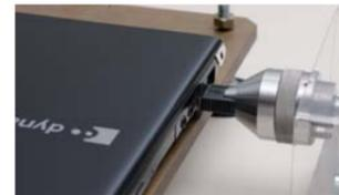
コネクタ部分に「こじり」(回転)によるストレスを加え、接続部の耐久性を確認します。
