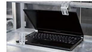
ディスプレイの開閉を連続的に実施し、PCのヒンジへの影響を確認します。
