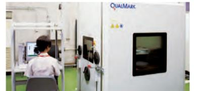
実験装置の中で、数年分の負荷に相当する急激な温度変化(-100℃~95℃)や強い振動などのストレステストを製品が壊れるまで行い、数年後に発生するかもしれない故障の可能性を見つけ出します。
