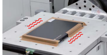
電車や車移動などで振動を受けることを想定し、テーブルをXYZの3方向それぞれで振動させてPCが壊れないか評価します。
