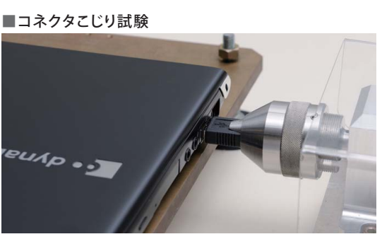
コネクタ部分に「こじり」(回転)によるストレスを加え、接続部の耐久性を確認します。
