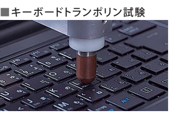
押したキーの周囲がどれくらいいたわむかを検証。ミリ単位で測定します。(Cシリーズを除く)
