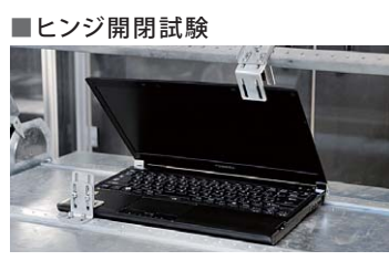
ディスプレイの開閉を連続的に実施し、PCのヒンジへの影響を確認します。
