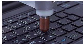
押したキーの周囲がどれくらいたわむかを検証。ミリ単位で測定します。(Cシリーズを除く)
