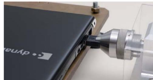
コネクタ部分に「こじり」(回転)によるストレスを加え、接続部の耐久性を確認します。
