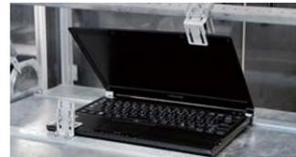
ディスプレイの開閉を連続的に実施し、PCのヒンジへの影響を確認します。
