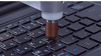
押したキーの周囲がどれくらいいたわむかを検証。ミリ単位で測定します。(Cシリーズを除く)
