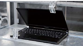
ディスプレイの開閉を連続的に実施し、PCのヒンジへの影響を確認します。
