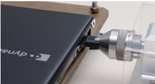
コネクタ部分に「こじり」(回転)によるストレスを加え、接続部の耐久性を確認します。
