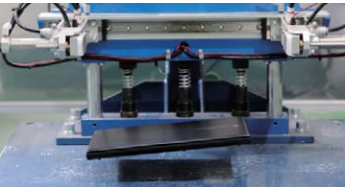
さまざまな角度から製品を落下させて、各部位の耐久性を調べます。
