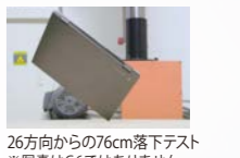
26方向からの76cm落下テスト ※写真はG6ではありません。
